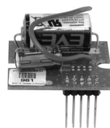
MODUŁ NADAJNIKA RADIOWEGO (do zainstalowania w obudowie)
