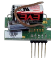
MODUŁ NADAJNIKA RADIOWEGO DO ZAINSTALOWANIA W OBUDWIE
