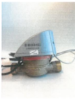
Fotografia nr 3: Oplombowanie kompaktowych ciepłomierzy typu Elf2 na plastikowym pierścieniu:
