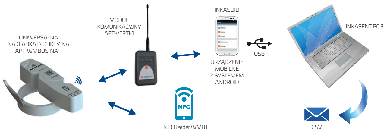
Rys. 1. Schemat połączeń w systemie telemetrycznym
