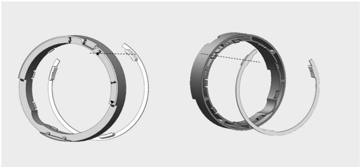
Rys. 17. Pozycjonowanie pierścienia blokującego przed montażem na pierścieniu pośrednim.
