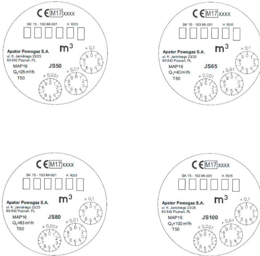
Rys. 7a: Przykład tarczy i oznakowania wodomierzy JS (próbki dla R315) oraz oznaczenia i adresu pocztowego producenta
