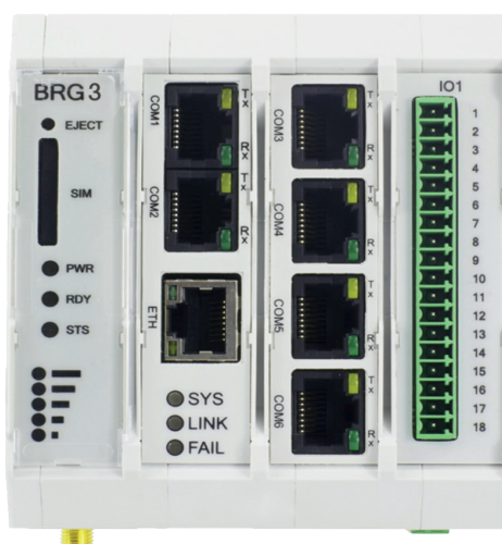
Przykładowa konfiguracja sterownika BRG 3 rozszerzonego o dodatkowy moduł komunikacyjny i moduł telemechaniki
